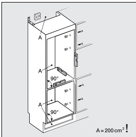
Перед встраиванием прибора следует выполнить тщательное выравнивание мебельного шкафа с помощью ватерпаса. Все углы шкафа должны составлять  $90^\circ$ , так как иначе дверца не будет прилегать со всех 4-х углов.
