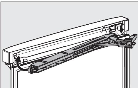
■ Вставьте амортизатор в дверцу, при этом установите его сначала со стороны прибора.
