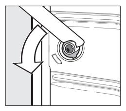
■ Поверните левый транспортировочный стержень на 90° с помощью прилагаемого гаечного ключа и
