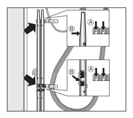
■ Закрепите транспортировочные стержни на задней стенке стиральной машины. Проследите за тем, чтобы при установке отверстия В были вставлены в цапфы (А).
