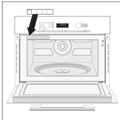
■ Наклейте прилагаемую краткую инструкцию так, чтобы не закрыть при этом вентиляционные отверстия.
