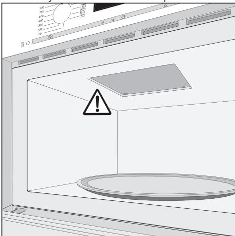
Не удаляйте крышку, расположенную в рабочей камере перед отверстием выхода микроволн.
