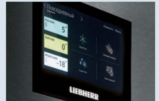
Для быстрого охлаждения и замораживания свежих продуктов с сохранением полезных витаминов и создания резерва холода подходят режимы **SuperCool** и/или **SuperFrost**. При активации SuperCool температура временно понижается до +2°C в холодильной камере, а при выборе SuperFrost до -32°C в морозильном отделении и отключатся автоматически в зависимости от времени работы или количества продуктов, тем самым способствуя экономии электроэнергии.
