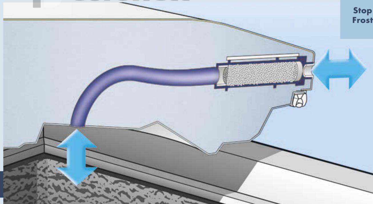
Инновационная система **StopFrost** имеет два основных преимущества: уменьшается образование инея на стенках морозильного ларя и на замораживаемых продуктах, что позволяет гораздо реже производить размораживание. Также благодаря ее использованию при открывании и закрывании крышки давление внутри ларя не понижается, поэтому ларь открывается без усилий.
