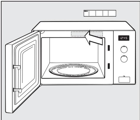
■ Наклейте прилагаемую краткую инструкцию так, чтобы не закрыть при этом вентиляционные отверстия.
