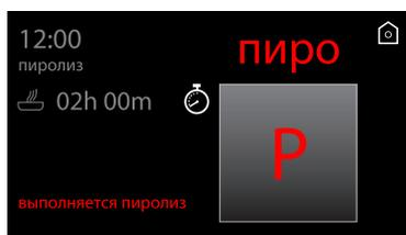
4. На дисплее появится надпись «выполняется пиролиз», указывающая на то, что прибор совершает цикл автоматической чистки. Через 2 минуты после начала пиролиза дверца духовки блокируется с помощью приспособления, которое предотвращает любую возможность ее открытия (на дисплее отображается символ
