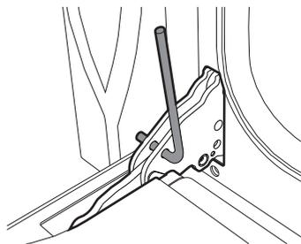
2. Возьмите дверцу за обе стороны двумя руками рядом с петлями, приподнимите ее под углом приблизительно 30° и выньте.
