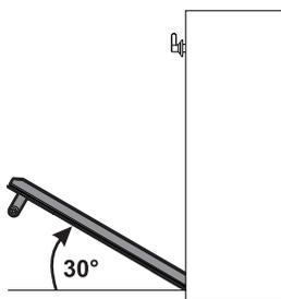
3. Чтобы снова установить дверцу, вставьте шарниры в подходящие пазы, расположенные на духовке, так, чтобы шлицы **A** полностью вошли в пазы. Опустите дверцу вниз и после ее установки выньте стержни из отверстий петель.
