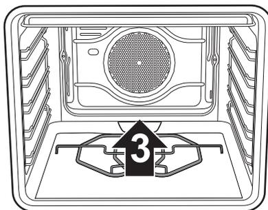
Поставьте на место основание противня для пиццы, подталкивая его до упора к задней части плиты и давая вклиниться в пластинку сопротивления на основании плиты.
