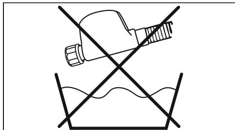
**Не погружать защитный корпус у шланга залива воды в жидкость!**
