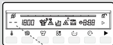
Если вы пропустили температуру, которую хотели выставить, вы можете вернуться к ней, нажимая на кнопку регулировки температуры воды.
