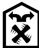
Zasysane powietrze jest oczyszczane przez filtr przeciwłuszcza oraz filtr z węglem aktywnym i odprowadzane z powrotem do kuchni.
