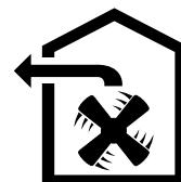
Nasávaný vzduch se čistí přes tukové filtry a potrubním systémem je odváděn ven.
