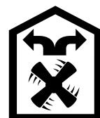
Nasávající vzduch se čistí pomocí tukového filtru a aktivního uhlíkového filtru a přivádí se zpět do kuchyně.
