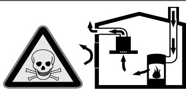
I focolari che dipendono dall'aria ambiente (peres. a gas, olio, legna o carbone, scaldabagno, caldaie elettriche) ricavano l'aria per la combustione dalla stanza ed eliminano i gas di scarico all'esterno attraverso un impianto (peres. camino).
