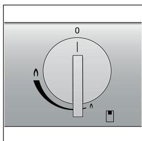
Oznaczenia na pokrętle pokazują pozycję danego palnika i ustawienie od płomienia małego do pełnego. Ustawienia są bezpoziomowe.
