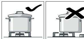
Устанавливайте варочную емкость посередине над горелкой, иначе возможно опрокидывание.
