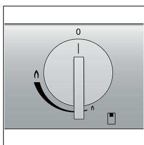
Маркировка ручек управления указывает на принадлежность к соответствующей конфорке и регулировку в диапазоне между малым и большим огнем. Эта регулировка является плавной.
