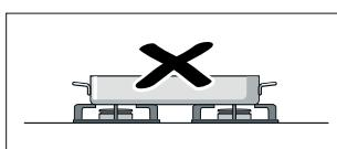
Nikdy neohřívejte nádobu na vaření (např. pekáč, pánev, kamenná grilovací deska) několika hořáky. Akumulací vysokých teplot se poškodí přístroj.
