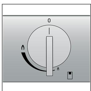
Značky u ovládacího knoflíku ukazují přiřazení k příslušnému hořáku a nastavení na minimální nebo maximální plamen. Nastavení je plynulé.
