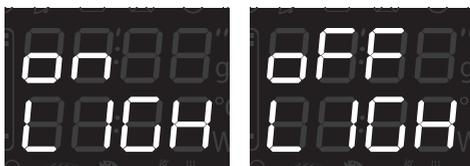
Для предотвращения автоматического отключения лампы по прошествии одной минуты необходимо установить данный режим на ВЫКЛ. (OFF).
