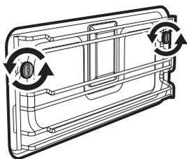
2. Потяните рамку вовнутрь отделения, чтобы снять ее с крепежных штырей.
