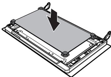
6. Выполните центровку и вставьте 4 стержня в гнезда на дверце духовки, слегка надавив на них.
