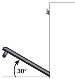
3. Чтобы снова установить дверцу, вставьте шарниры в соответствующие пазы, расположенные на духовке, так чтобы шлицы **A** полностью вошли в пазы. Опустите дверцу вниз, установите ее и извлеките штифты из отверстий петель.
