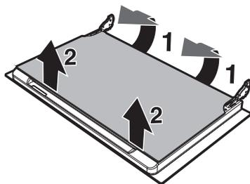
3. На некоторых моделях имеется промежуточный стеклопакет. Снимите промежуточный стеклопакет, приподнимая его вверх.
