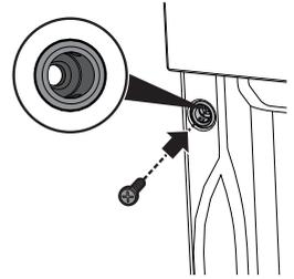
Закройте втулки ранее снятыми заглушками.
