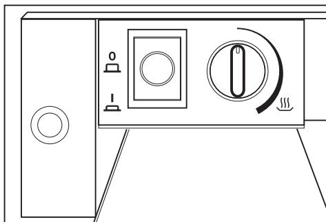
К элементам управления относятся переключатель температуры и выключатель Вкл/Выкл. Они видны только при открытом положении выдвижного ящика.
