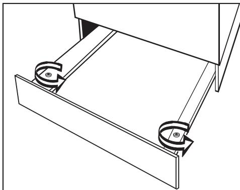
Выровняйте фронтальную панель и зазор с помощью подкладных шайб, выполняя
