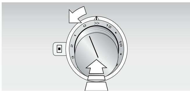
**Выключение** Поверните ручку управления на любую другую ступень мощности Символ **>>** на индикации конфорки гаснет
