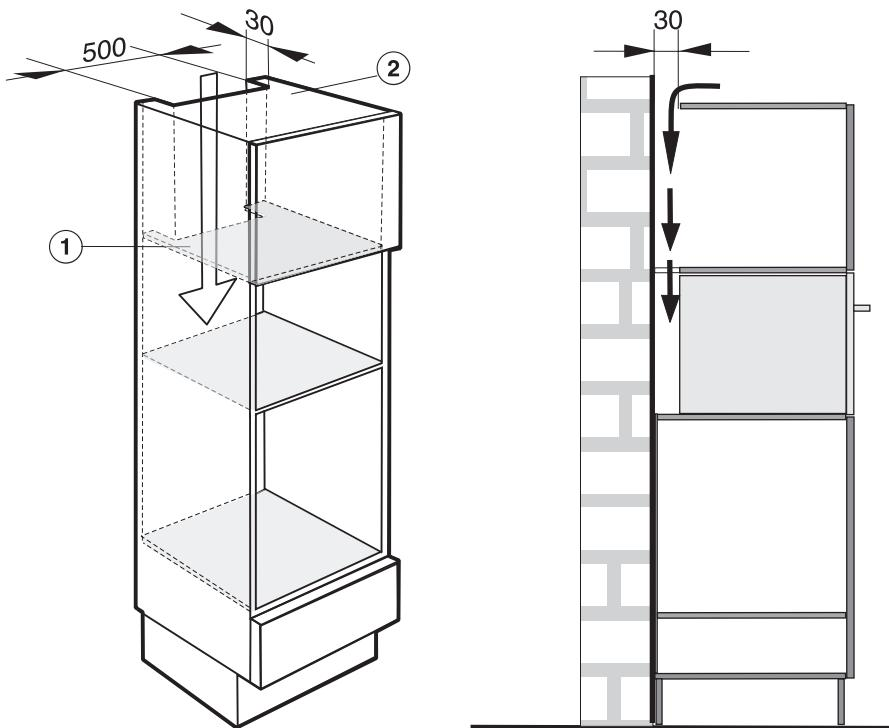
Чтобы обеспечить вентиляцию прибора, в сплошной полке ① вверху ниши для встраивания и с верхней стороны корпуса мебели ② должен быть предусмотрен вырез 500x30 мм.
