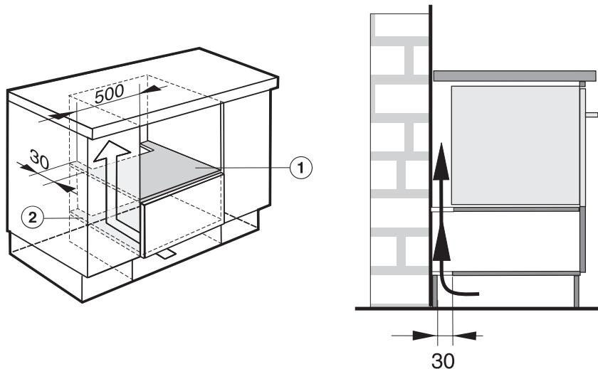
Чтобы обеспечить вентиляцию прибора, в днище ниши для встраивания ① и с нижней стороны корпуса мебели ② должен быть предусмотрен вырез 500x30 мм.
