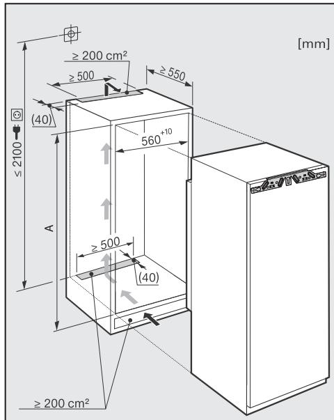
Перед встраиванием убедитесь, что шкаф для встраивания точно соответствует приведенным размерам для встраивания. Для корректной работы прибора должны быть обязательно соблюдены приведенные сечения вентиляционных отверстий.
