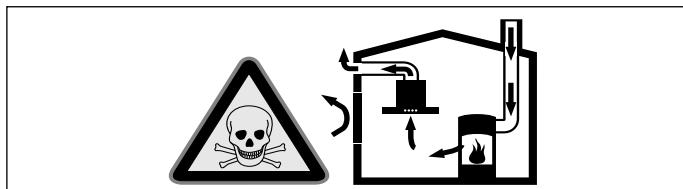
Uzavřené spotřebiče paliv (např. tepelné spotřebiče na plyn, olej, dřevo nebo uhlí, průtokové ohřívače, bojlery) odebírají spalovací vzduch z místnosti, ve které jsou nainstalované, a spaliny odvádějí zařízením pro odvod spalin (např. komínem) ven.
