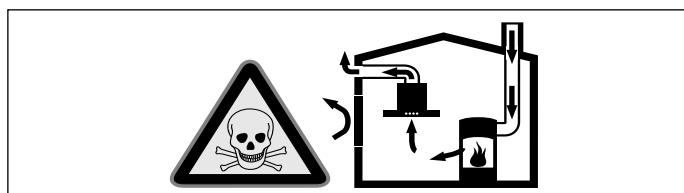
Hava dolaşımı ateşlikler (örneğin gaz, yağ, odun veya kömürle çalışan sobalar, şofbenler, su ısıtıcıları) yanma havasını kurulum yerinden alırlar ve atık gazı bir atık gaz sistemi (örneğin baca) kanalıyla dışarıya aktarırlar.
