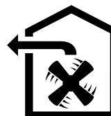
Zassane powietrze jest czyszczone przez filtr przeciwłuszczały i kierowane na zewnątrz poprzez system rur.
