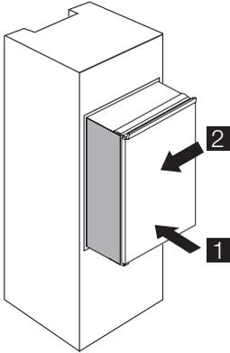
3. Richten Sie das Gerät in der Einbaunische aus. Vergewissern Sie sich, dass der Abstand zwischen dem Gerät und der Schrankvorderkante 44 mm beträgt. Mit der unteren Scharnierabdeckung (im Beipack) können Sie sicherstellen, dass der Abstand zwischen dem Gerät und dem Küchenmöbel richtig ist. Achten Sie darauf, dass der Abstand zwischen dem Gerät und dem Schrank 4 mm beträgt. Öffnen Sie die Tür. Stecken Sie die untere Scharnierabdeckung auf.
