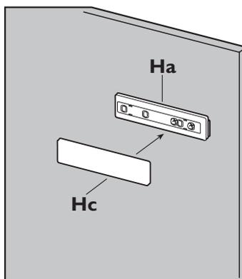
10. Öffnen Sie die Gerätetür und die Tür des Küchenmöbels in einem Winkel von 90°. Setzen Sie das Führungsstück (Hb) in die Führungsschiene (Ha) ein. Bringen Sie die Gerätetür und die Küchenmöbeltür zusammen und markieren Sie die Bohrungen.
