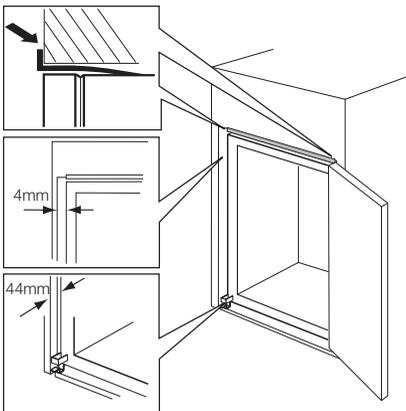
4. Befestigen Sie das Gerät mit 4 Schrauben in der Einbaunische.
