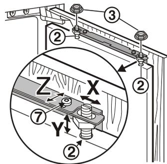
9. Möbeltür in der Tiefe Z ausrichten: Die Schrauben ⑦ lösen.
