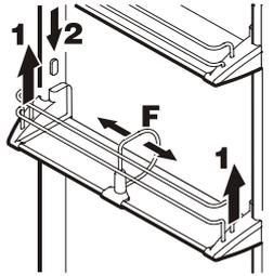
Platz für hohe Gefäße ermöglichen die **halben Glasplatten**. Beiliegende Auflageschienen, Abb. 1, in gewünschter Höhe rechts und links auf die Auflagenoppen aufstecken.
