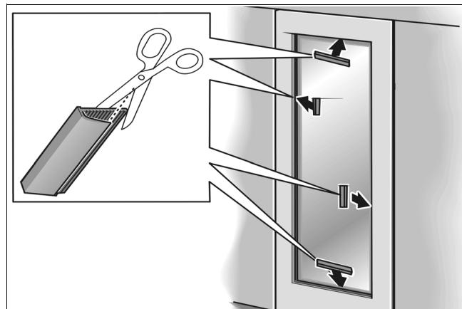
Если ширина рамки небольшая, то, при определенных обстоятельствах, нужно будет укоротить одну сторону защитной планки. Для определения необходимой длины этой стороны в комплект поставки входит несколько защитных планок различной длины.
