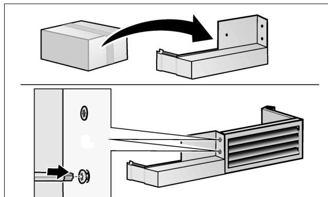
Для приведения вентиляционной решетки в соответствие с измененным направлением открывания дверцы к комплекту прибора прилагается сменная деталь.
