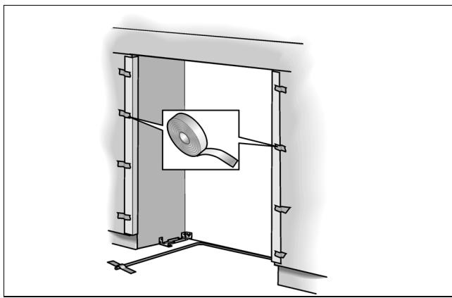
Для защиты краев ниши для встраивания бытового прибора от повреждений к ним следует прикрепить с помощью клейкой ленты входящие в комплект поставки защитные планки.
