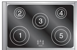
Под каждой зоной готовки находится бобина, которая называется *индуктор*, подключается к электронной системе и создает переменное магнитное поле. Когда кастрюля помещается в подобное магнитное поле, высокочастотный ток сосредотачивается непосредственно на кастрюле и вырабатывают тепло, необходимое для приготовления продуктов.
