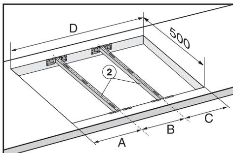
При встраивании **трех приборов** ширина выреза в столешнице D получается из размеров A и B и C.
