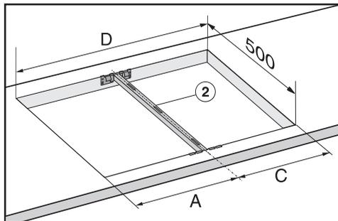
При встраивании **двух приборов** ширина выреза в столешнице D получается из размеров A и C.
