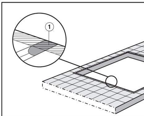
Места стыка ① и заштрихованная область под нижней поверхностью прибора должны быть гладкими и плоскими, чтобы край газовой панели конфорок лежал ровно, и уплотнительная лента под краем верхней части прибора обеспечивала достаточную герметизацию рабочей поверхности.
