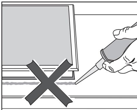
Герметик ни в коем случае не должен попадать между рамкой верхней части прибора и столешницей!
