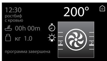
2. Для выполнения нового процесса приготовления с уже заданными параметрами нажмите на символ (нажать два раза, если включена звуковая сигнализация). Если прибор еще нагрет, он автоматически начнет процесс приготовления, в противном случае он начнет фазу предварительного нагрева.
