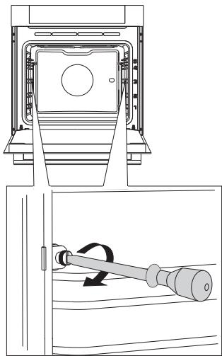
**1** Открутите винт с помощью отвертки.
