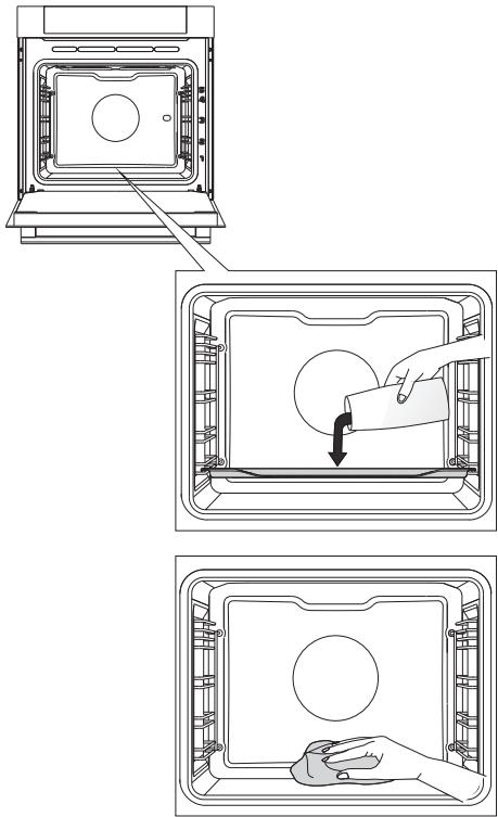
**1** Поверните ПЕРЕКЛЮЧАТЕЛЬ РЕЖИМА НАГРЕВА в положение AquaClean. На дисплее загорятся символ режима нагрева, ПРЕДУСТАНОВЛЕННАЯ ТЕМПЕРАТУРА и время 30 минут.
