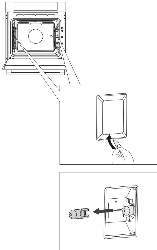
**1** С помощью отвертки снимите крышку.
