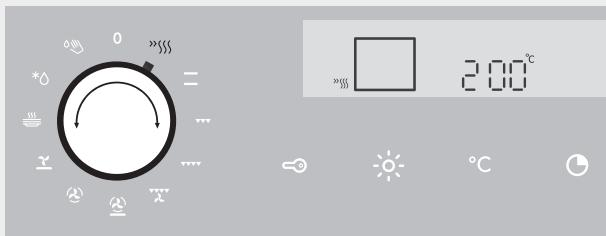
Установите переключатель РЕЖИМА НАГРЕВА в положение «Размораживание». На дисплее отобразится ВРЕМЯ, которое вы можете поменять. Нажмите на сенсор СТАРТ/СТОП.
