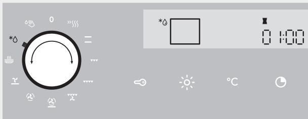
Установите переключатель РЕЖИМА НАГРЕВА в положение «Быстрый нагрев». На дисплее появится ПРЕДУСТАНОВЛЕННАЯ ТЕМПЕРАТУРА, которую можно поменять.
