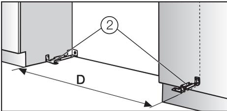
Расстояние "D" между устройствами защиты от опрокидывания ② точно соответствует ширине прибора.
