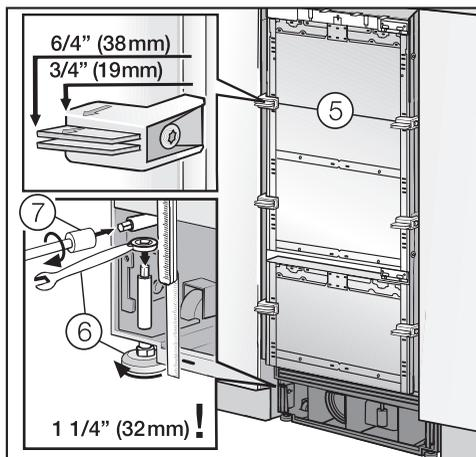
Вспомогательные элементы (5) на двери прибора предназначены для мебельных фронтов следующей толщины:
