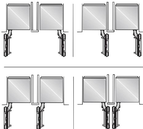
Промежуточная стенка может быть толщиной мин. 16 мм.
