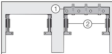
Если ниша глубже чем прибор, то подложите массивные деревянные бруски ① позади устройства защиты от опрокидывания ② и надежно прикрепите их к полу или стене.
