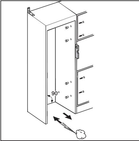
Перед встраиванием прибора следует выполнить тщательное выравнивание мебельного шкафа с помощью ватерпаса. Все углы шкафа должны составлять  $90^\circ$ , в противном случае мебельная дверца не будет прилегать ко всем 4 углам шкафа.
