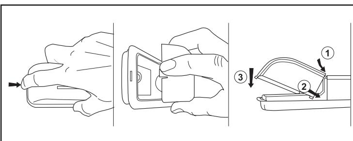
Отвинтите лампу, чтобы вынуть ее из лампового патрона. Замените лампу равнозначной (E14, макс. 15 Вт) и завинтите ее.
