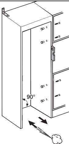
Перед встраиванием прибора следует выполнить тщательное выравнивание мебельного шкафа с помощью ватерпаса. Все углы шкафа должны составлять 90°, в противном случае мебельная дверца не будет прилегать ко всем 4 углам шкафа.
