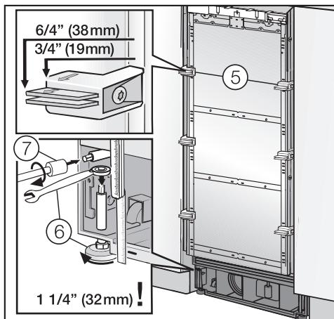
Вспомогательные элементы ⑤ на двери прибора предназначены для мебельных фронтов следующей толщины:
