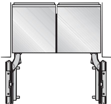
Если между приборами, расположенными рядом, нет промежуточной стенки, то приборы могут быть прикреплены друг к другу с помощью монтажного комплекта Side-by-side.
