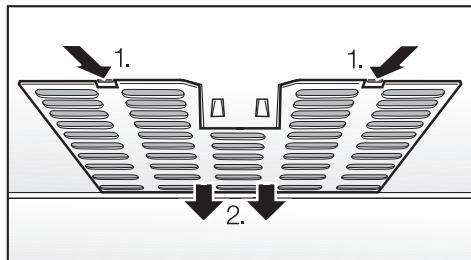
■ Отоприте крышку фильтра ① и снимите ее вместе с фильтрующим матом вниз ②.
