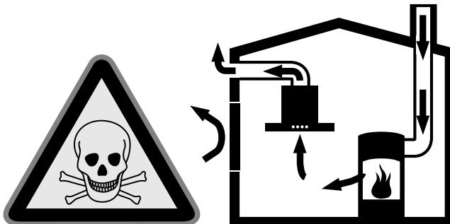
Приборы с открытым пламенем, зависящие от воздуха в помещении (например: нагревательные приборы на газе, солярке, дровах или на угле, поточные нагреватели, водоподогреватели, конфорки и духовые шкафы), потребляют для горения воздух из помещения установки, а отработанный воздух отводится через систему выпуска (например, камин) наружу.
