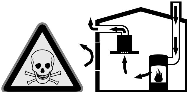
Topeníště závislá na vzduchu v místnosti (např. topení na plyn, olej, dřevo nebo uhlí, průtokové ohříváče, ohříváče vody, varné desky, trouby) získávají vzduch potřebný ke spalování z místnosti, kde jsou instalovány, a odvádějí spaliny zařízením na odvod spalin (např. komín) ven.
