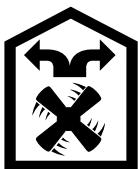
Zassane powietrze jest czyszczone przez filtr tłuszczu i filtr z węglem aktywnym, potem znów kierowane z powrotem do kuchni.
