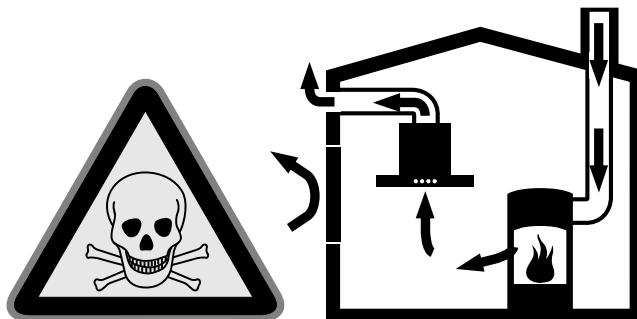
Zależne od powietrza w pomieszczeniu miejsce spalania (np. grzejniki na gaz, olej, drewno lub węgiel, przepływowie podgrzewacze wody, podgrzewacze wody) pobierają powietrze do spalania z pomieszczenia, w którym je wbudowano a spaliny odprowadzają przez układ wydechowy (np. kominek) na zewnątrz.
