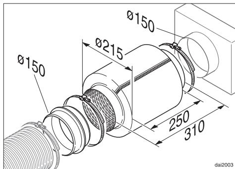
В вытяжную систему может быть установлен шумоподавитель. Он предназначен для дополнительного шумоподавления.
