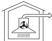
Всасываемый воздух очищается жироулавливающими фильтрами и выводится наружу.
