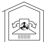
Всасываемый воздух очищается жироулавливающими фильтрами и дополнительно **угольным фильтром**. Через отверстия в телескопической трубе вытяжки воздух попадает обратно в кухню.
