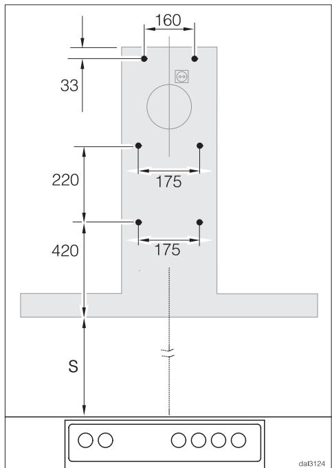
Для предварительного изготовления задней стенки здесь указаны расстояния между отверстиями (шурупы Ø 5 мм).
