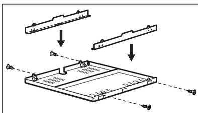
Якщо використовується захисний короб (додаткове приладдя<sup>1)</sup>), захисне покриття безпосередньо під приладом не потрібне. Не слід використовувати захисний короб при встановленні приладу над духовою шафою.
