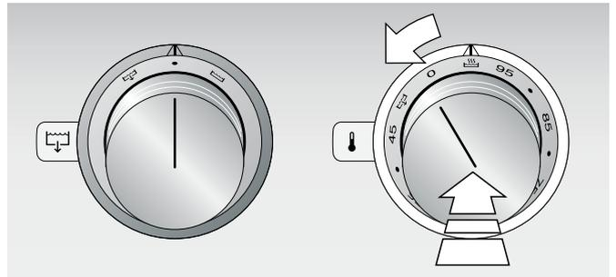
Cihaz ısındığı sürece sıcaklık kumanda düğmesinin arkasındaki ışıklı halka yanıp söner. Ayarlanan sıcaklığa ulaşıldığında ışıklı halka sürekli yanar.
