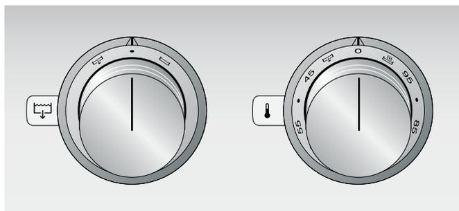
Pravým ovládacím knoflíkem volíte teplotu mezi 45–95 °C nebo stupeň přípravy v páře ☁.
