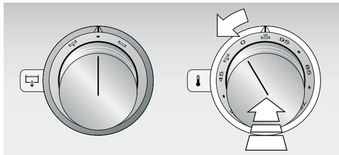
Pierścień świetlny za pokrętką obsługi miga do momentu nagrzania się urządzenia. Po osiągnięciu nastawionej temperatury pierścień świetlny świeci się bez przerwy.
