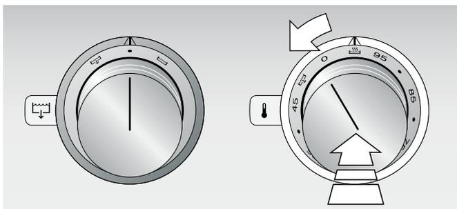
Světelný kroužek za ovládacím knoflíkem teploty bliká, dokud se přístroj nahřívá. Po dosažení nastavené teploty svítí světelný kroužek trvale.
