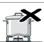
Не пользуйтесь деформированными варочными емкостями, так как они не обладают устойчивостью при установке на конфорку. Такие емкости могут опрокидываться.
