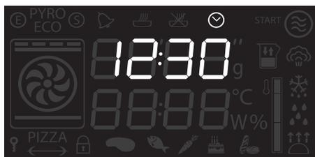
**ON (Включ):** При запуске одной из функций на дисплее отображаются установленные параметры, такие как температура, длительность и уровень достижения температуры.
