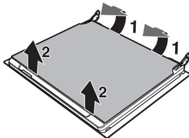
3. На многофункциональных моделях имеется промежуточное стекло. Снимите промежуточные стекла, приподнимая их кверху.
