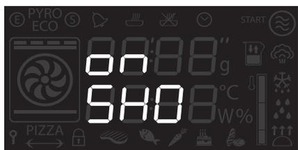
**Режим Низкой Мощности:** Данный режим позволяет ограничить потребляемую мощность прибора. Предназначен для использования нескольких бытовых приборов одновременно.
