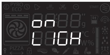
Для предотвращения автоматического отключения лампы по прошествии одной минуты необходимо установить данный режим на Выкл. (OFF).
