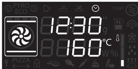
При каждом нажатии ручки температуры во время действия одной из функций показываются значения параметров функции в приведенном ниже порядке. Значение каждого параметра можно изменить поворачивая ручку температуры вправо или влево. Удерживайте ручку повернутой, чтобы ускорить увеличение или уменьшение.
