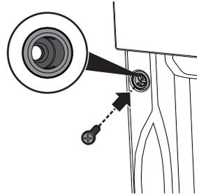
Закройте втулки ранее снятыми заглушками.
