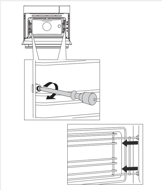
**1** Открутите винты с помощью отвертки.
