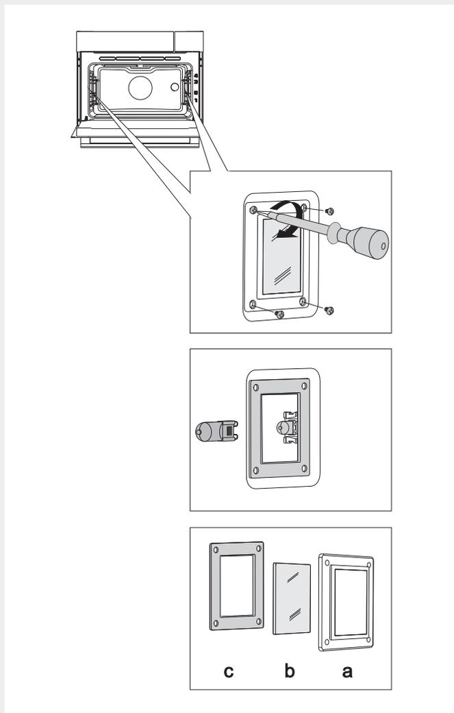
**1** Открутите четыре винта на крышке. Снимите крышку.
