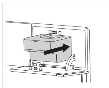
**1** Откройте крышку отсека резервуара, нажав на нее.
