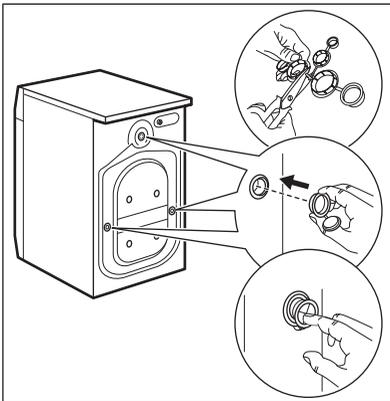
12. Вставьте в отверстия пластиковые заглушки. Заглушки находятся в пакете с инструкцией по эксплуатации.
