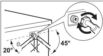
6. Подсоедините наливной шланг обратно. Во избежание утечек воды проверьте герметичность всех гидравлических соединений.
