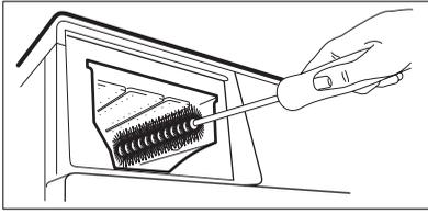
5. Очистите нишу дозатора с помощью щетки.
