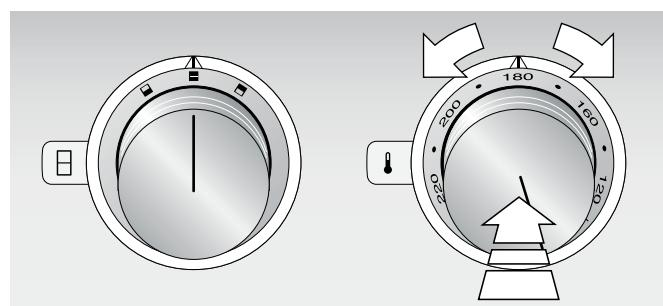
Isıtma alanının tamamını kullanarak kızartmak istemiyorsanız, sol kumanda düğmesiyle sadece ön veya arka kısmı seçebilirsiniz. Sol kumanda düğmesine basın ve istenilen ısıtma alanı olarak **■** veya **□** seçimini yapın.
