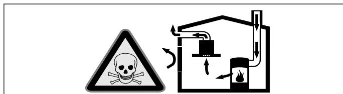
Hava dolaşımı ateşlikler (örneğin gaz, yağı, odun veya kömürle çalışan sobalar, şofbenler, su ısıtıcıları) yanma havasını kurulum yerinden alırlar ve atık gazı bir atık gaz sistemi (örneğin baca) kanalıyla dışarıya aktarırlar.
