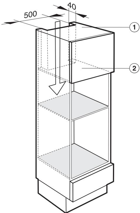
Для обеспечения вентиляции прибора должны быть предусмотрены прорези 500x40 мм:
