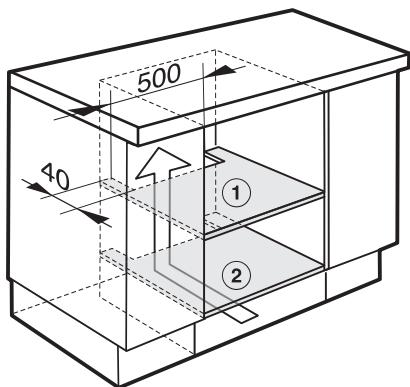
Для обеспечения вентиляции прибора должны быть предусмотрены прорези 500x40 мм:
