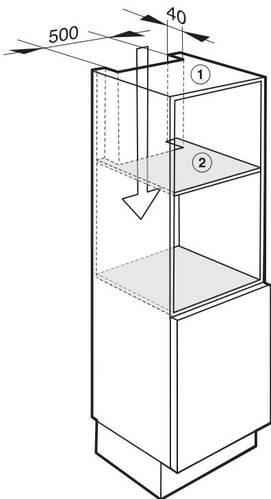
Для обеспечения вентиляции прибора должны быть предусмотрены прорези 500x40 мм:
