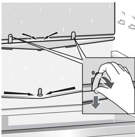
Avec un bâtonnet ouaté ou assimilé, nettoyez régulièrement les rigoles et le trou d'écoulement de l'eau de dégivrage afin que cette eau puisse bien s'écouler. Pour la nettoyer, il est possible d'extraire la rigole supérieure servant à faire écouler l'eau de dégivrage.
