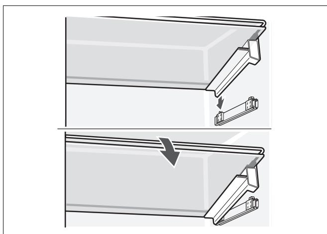
Posizionare il ripiano in vetro sul fondo, infilarlo e agganciarlo premendo la parte anteriore del ripiano.
