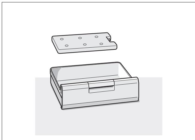
Lors d'une coupure de courant ou en cas de panne, les accumulateurs de froid retardent le réchauffement des produits surgelés stockés dans l'appareil. Vous pouvez également vous servir des accumulateurs de froid pour emporter des aliments par ex. dans un sac isotherme et les conserver ainsi au frais pendant une durée limitée.
