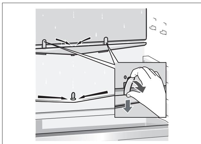
Dooiwatergootjes en afvoergaatje regelmatig met een wattenstaafje of iets dergelijks schoonmaken zodat het dooiwater kan weglopen. Het bovenste dooiwatergootje kan eruit gehaald worden om schoon te maken.
