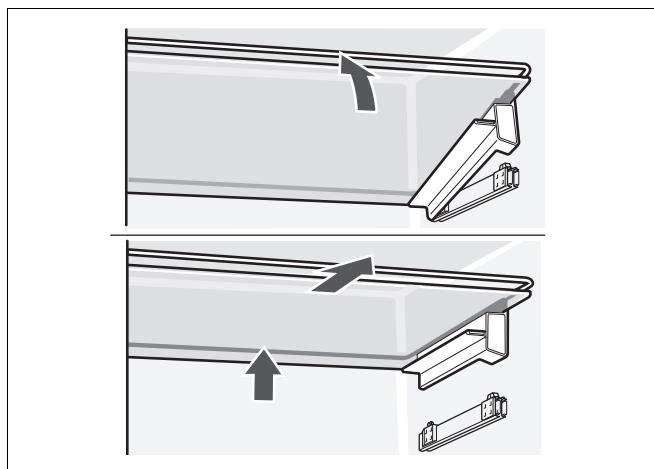
De uittrekbare glasplaat kan er pas uit gehaald worden als eerst de serveerschaal eruit gehaald wordt.
