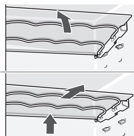
De glasplaat om eruit te halen schuin naar boven trekken en eruit halen.
