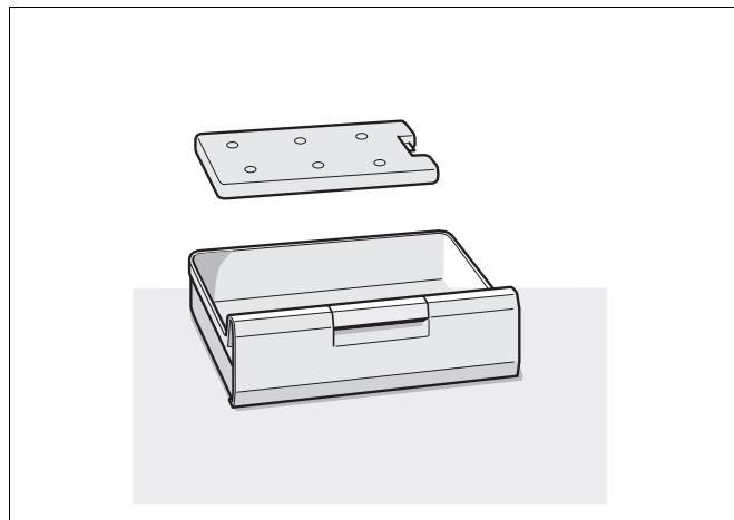
De koude-accu vertraagt bij het uitvallen van de stroom of bij een storing het verwarmen van de opgeslagen diepvrieswaren. De koude-accu kan ook voor het tijdelijk koelhouden van levensmiddelen (bijv. in een koeltas) eruit genomen worden.
