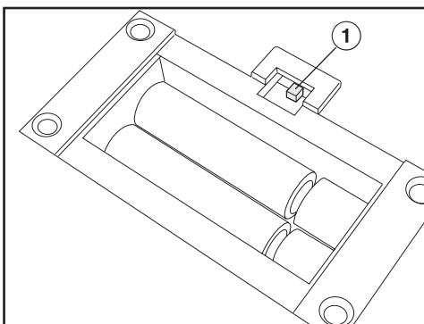
Bryteren ① for skifte av vektenhet befinner seg i batterirommet.
