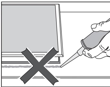
Taśma uszczelniająca pod krawędzią górnej części urządzenia zapewnia wystarczające uszczelnienie do blatu roboczego.
