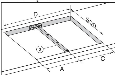
Przy zabudowie **dwóch urządzeń** szerokość wycięcia w blacie roboczym D wynika z wymiarów A i C.
