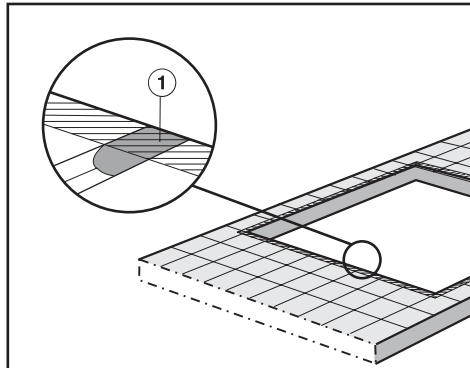
Fugen ① og det skraverte området under bæreflaten til innbyggingskaret må være glatt og jevn, slik at rammen ligger jevnt og tetningsbåndet under kanten til apparatets øvre del gir tilstrekkelig tetning mot benkeplaten.
