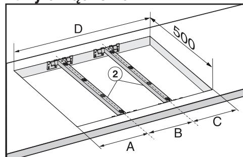
Przy zabudowie **trzech urządzeń** szerokość wycięcia w blacie roboczym D wynika z wymiarów A, B i C.
