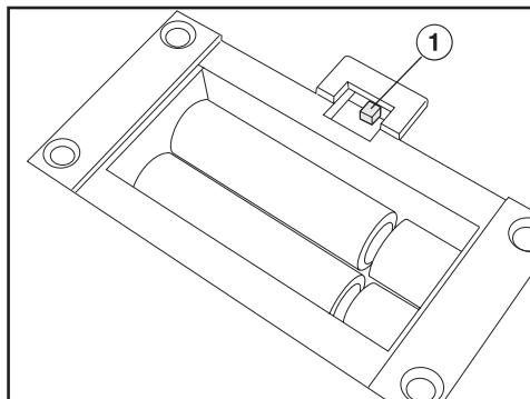
Przełącznik ① do przestawiania jednostek ciężaru znajduje się w komorze baterijnej.
