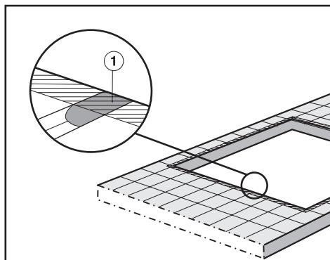
Fugi ① i zakreskowany obszar pod powierzchnią przylegania górnej części urządzenia muszą być gładkie i płaskie, żeby ramka równomiernie przylegała a taśma uszczelniająca pod krawędzią górnej części urządzenia zapewniała wystarczające uszczelnienie do blatu roboczego.
