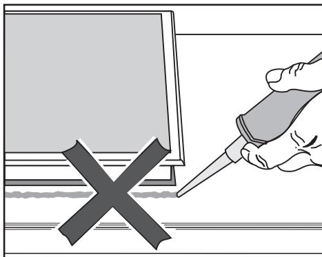
Tetningsbåndet under kanten på apparatets overdel sikrer tilstrekkelig tetning mot benkeplaten.
