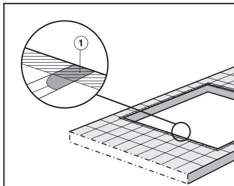
Fugerne ① og det skraverede område under produktets bæreflade skal være glatte og jævne, så rammen slutter ensartet til, og tætningslisten under kanten på produktets overdel giver tilstrækkelig tætning til bordpladen.
