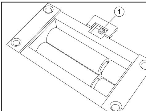
Kontakten ① til omstilling af vægtenheden sidder i batterirummet.
