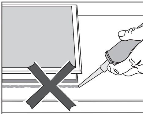
Der må ikke anvendes tætningsmiddel, medmindre det udtrykkeligt angives. Tætningslisten under kanten på produktets overdel sikrer, at produktet slutter helt tæt til bordpladen.
