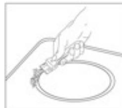
**Пригоревший сахар** и расплавленную пластмассу следует удалить немедленно, пока они еще горячие, при помощи скребка. Затем удалите загрязнения как это описано в пункте 2.
