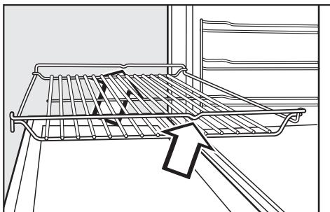
Задвиньте элементы с фиксатором назад.
