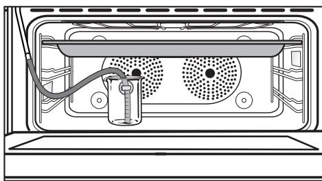
❶ Закрепите шланг на конце трубы для залива. Расположите другой конец пластикового шланга у дна емкости и закрепите шланг в емкости с помощью вакуумной присоски.
