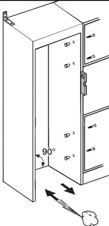
Перед встраиванием прибора следует выполнить тщательное выравнивание мебельного шкафа с помощью ватерпаса. Все углы шкафа должны составлять  $90^\circ$ , в противном случае мебельная дверца не будет прилегать ко всем 4 углам шкафа.
