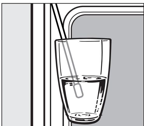
■ Погрузите наполнительную трубку в емкость с водопроводной водой.
