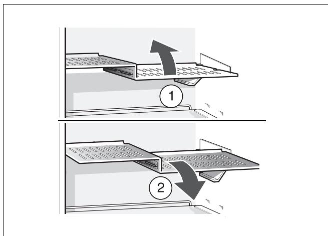
Sollevare il ripiano a gradini, tirarlo in avanti, abbassarlo e ruotarlo lateralmente.
