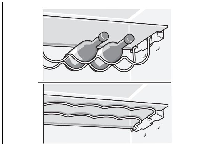
In der Flaschenablage können Flaschen sicher abgelegt werden. Wird der Platz für andere Lebensmittel benötigt, können die Metallbügel nach oben geklappt werden.
