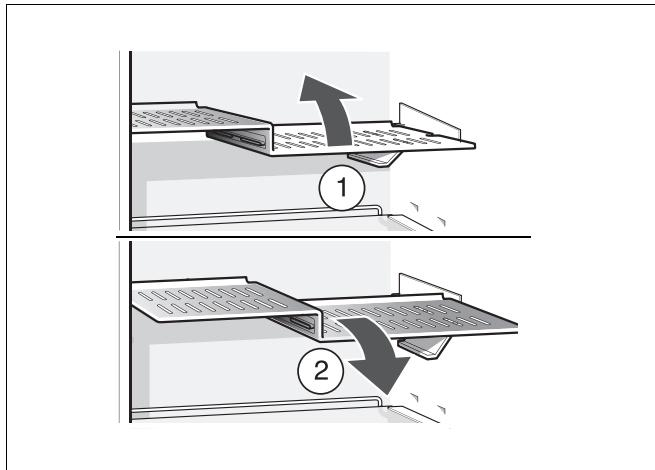
Getrapte legplateau iets optillen, naar voren trekken, laten zakken en zijdelings eruit zwenken.
