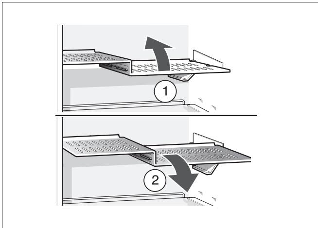
Stufenablage anheben, nach vorne ziehen, absenken und seitlich herausschwenken.
