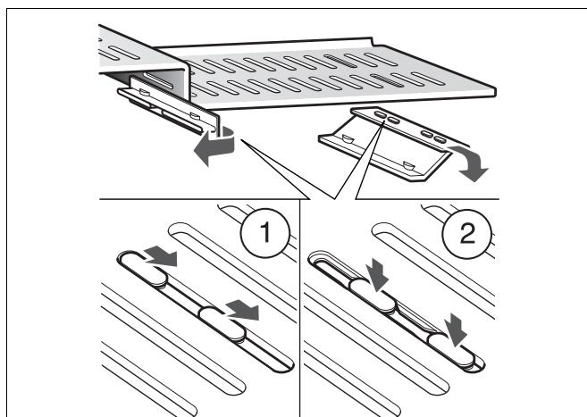
S'il faut utiliser une autre taille de bac gastronorme, il est possible de modifier les positions des fixations.
