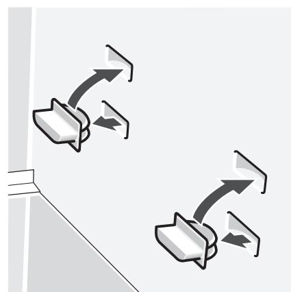
Die Position der Glasablage kann verändert werden, indem Sie die Stopfen versetzen.
