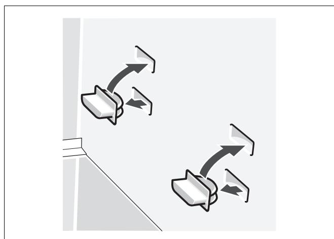
De positie van de glasplaat kan gewijzigd worden door de stopjes te verzetten.
