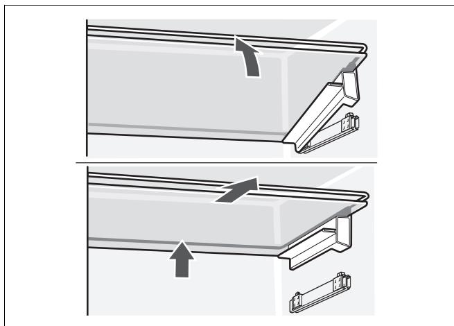
Glasplaat aan de voorkant uit de vergrendeling trekken en eruit halen.
