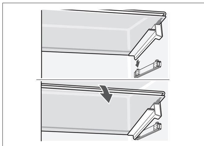
Glasablage hinten auflegen, einfädeln und vorne durch niederdrücken der Ablage einrasten.
