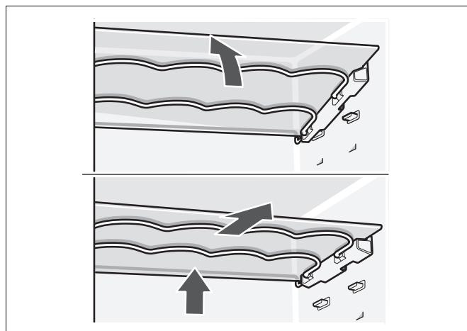
De glasplaat om eruit te halen schuin naar boven trekken en eruit halen.
