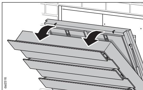
Если при закрывании из-за касания или заклинивания предметов корпус вытяжки будет заблокирован, то он будет выдавлен из верхнего крепления жироулавливающего фильтра и откроется, мотор прекратит работу.
