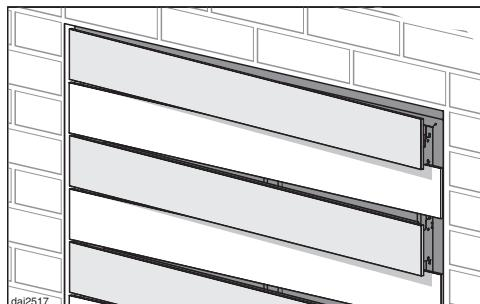
Выдвигающиеся пластины обладают также системой разблокировки. Если они будут заблокированы, то они могут открываться или закрываться с одной стороны.
