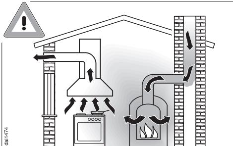
► При одновременной эксплуатации кухонной вытяжки и устройства горения, зависимого от комнатного воздуха, в одном помещении или при соединении систем вентиляции требуется особая осторожность.
