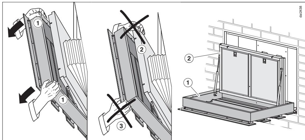
Для очистки внутренней поверхности вытяжки, для снятия жироулавливающего фильтра и для замены осветительных элементов корпус вытяжки может быть открыт.
