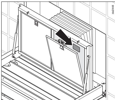
Типовая табличка находится за жироулавливающими фильтрами. Для снятия жироулавливающего фильтра необходимо привести корпус вытяжки в положение техобслуживания (см. "Чистка и уход").
