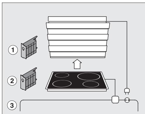
Докупаемый коммуникационный модуль XKM 2000 DA ① позволяет автоматически управлять вытяжкой в зависимости от рабочего состояния независимой варочной панели Miele.
