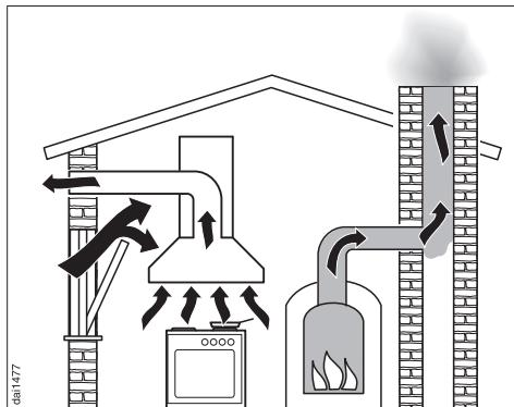
Этого можно добиться, если с помощью постоянно имеющихся отверстий, например, незакрывающихся форточек в дверях и окнах, обеспечить дополнительное поступление воздуха, необходимого для горения. При этом нужно проследить, чтобы сечение такого отверстия было достаточного размера.
