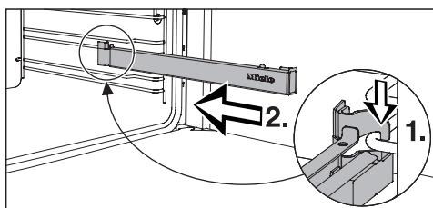
■ Зацепите направляющую FlexiClip передней частью на нижней опоре уровня (1.) и поверните ее вдоль опоры к рабочей камере (2.).
