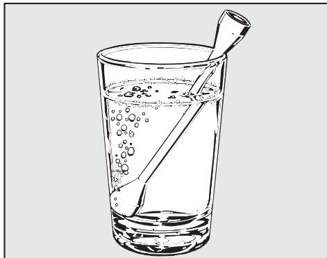
При варке, особенно при дополнительном нагреве жидкостей в режиме СВЧ без стержня для кипячения возможно, что хотя температура кипения и достигается, однако типичные пузырьки при кипении еще не поднимаются. Жидкость кипит неравномерно. Эта задержка кипения может привести при вынимании емкости или при сотрясении к неожиданному началу образования пузырьков или к неожиданному, взрывному выкипанию.
