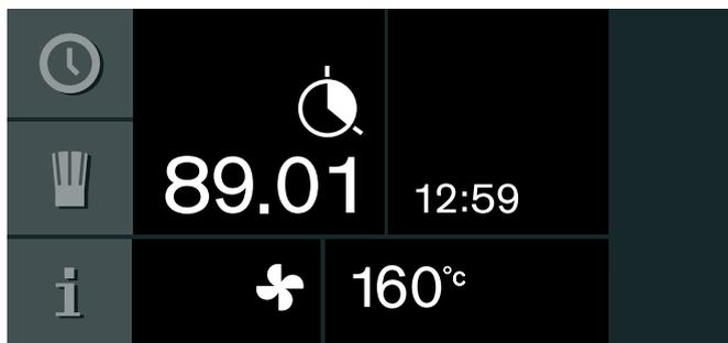
После окончания времени приготовления прибор выключается. Мигает символ ⌚ и выдается звуковой сигнал. Он прекращается, как только Вы коснетесь к символу ✓, откроете дверь прибора или установите переключатель функций на 0 .
